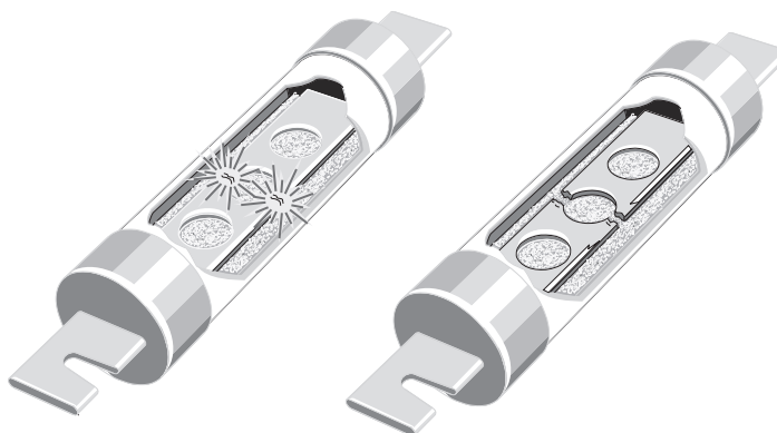
Fusible durante la falla
